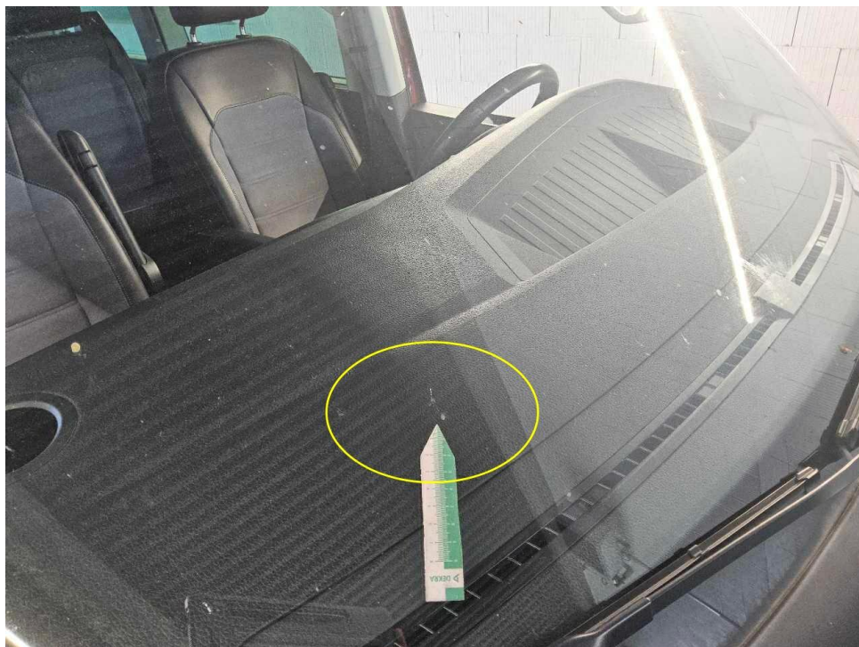
Bild 20 : Frontscheibe Steinschlag mit Rissbildung
