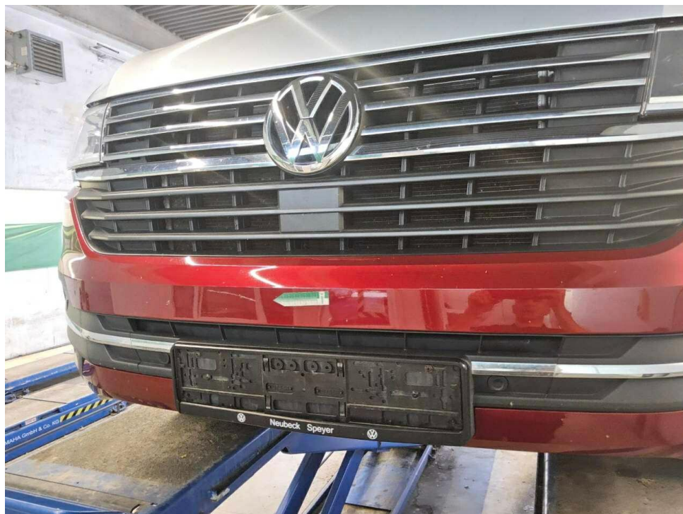
Bild 14 : Stoßfänger vorne Lackierung, zerkratzt, Gebrauchsspur
