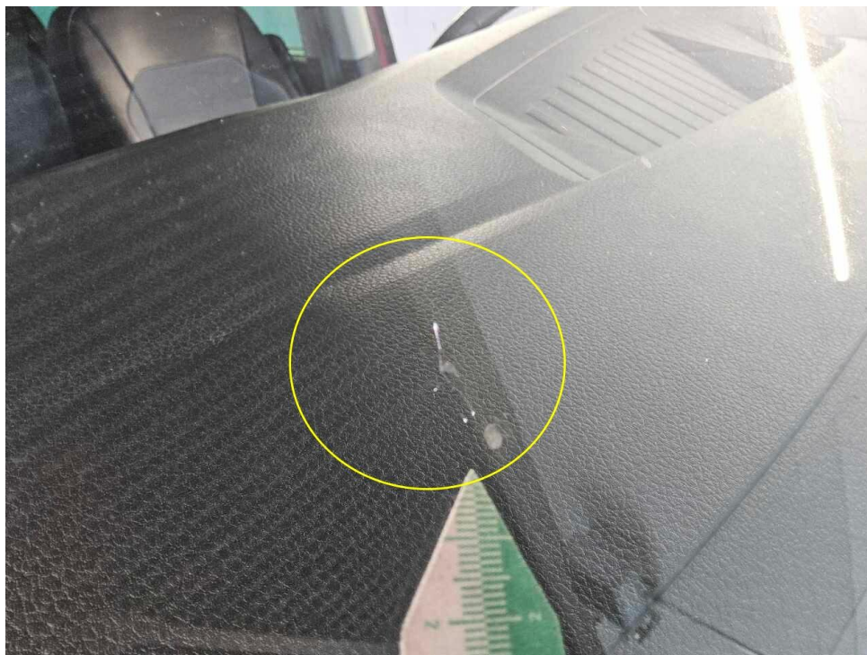
Bild 19 : Frontscheibe Steinschlag mit Rissbildung
